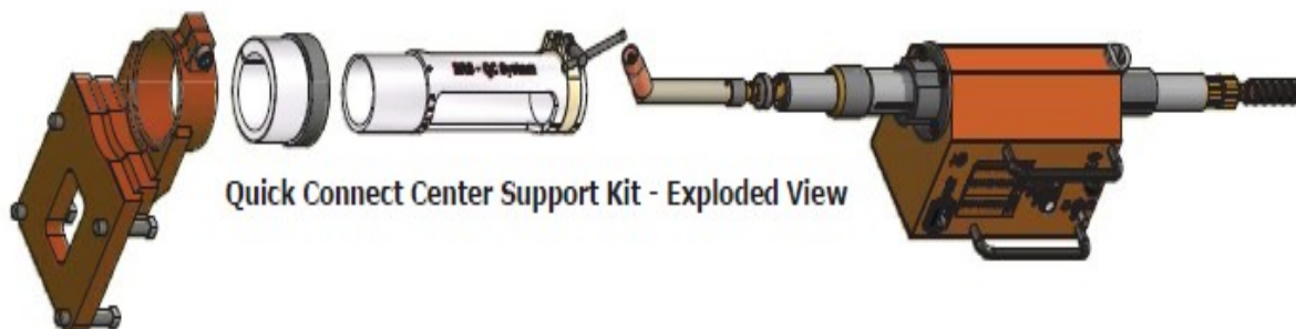
Sistema de acoplamento da soldadora na montagem da mandrilhadora
